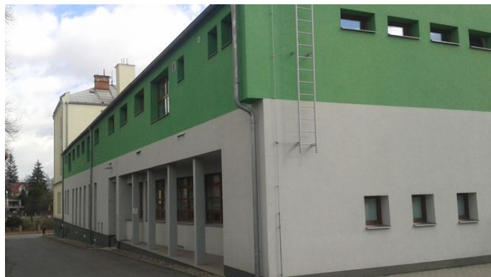
obr. /26/ Pro výlez na střešní rovinu přístavby slouží fasádní žebřík
