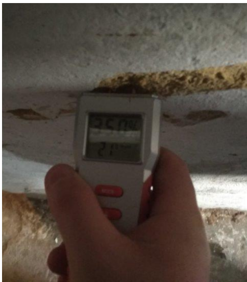
obr. /2/ Vlhkost omítky v suterénu 35 %
